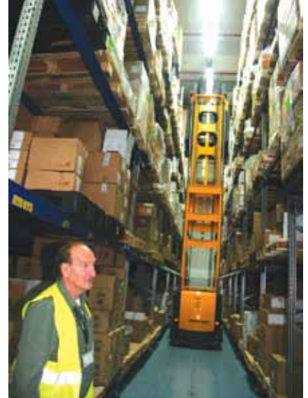
מערכת ממוחשבת למניעת פגיעה במתזים ובגופי תאורה. בנוסף למערכת לזיהוי אדם למניעת פגיעה
